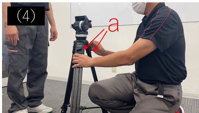
(4) 三脚の下の脚部分が伸ばすために、三脚のaのネジ部分を緩めます。
