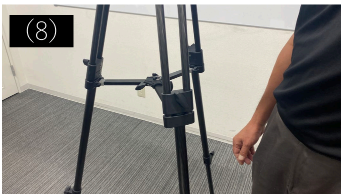
(8) 三脚の脚を伸ばしてcのネジ部分を締めたら、三脚がしっかり立つかどうか確認してください。
