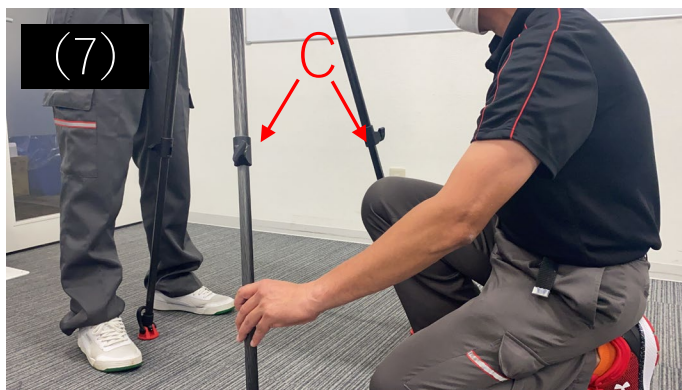
(7) aのネジ部分からさらに下にあるcのネジ部分を緩めて、写真のように脚をさらに伸ばします。
