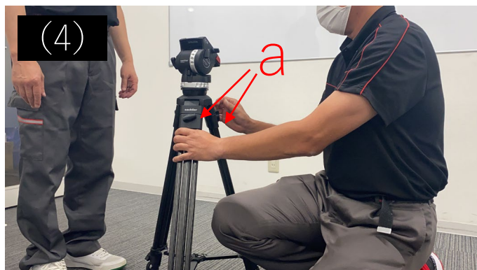
(4) 三脚の下の脚部分を伸ばすために、三脚のaのネジ部分を緩めます。
