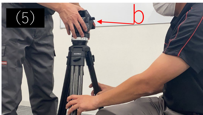
(5) 一人が三脚上部の脚部分を持って、もう一人が三脚上部のb部分を持って引き上げます。
